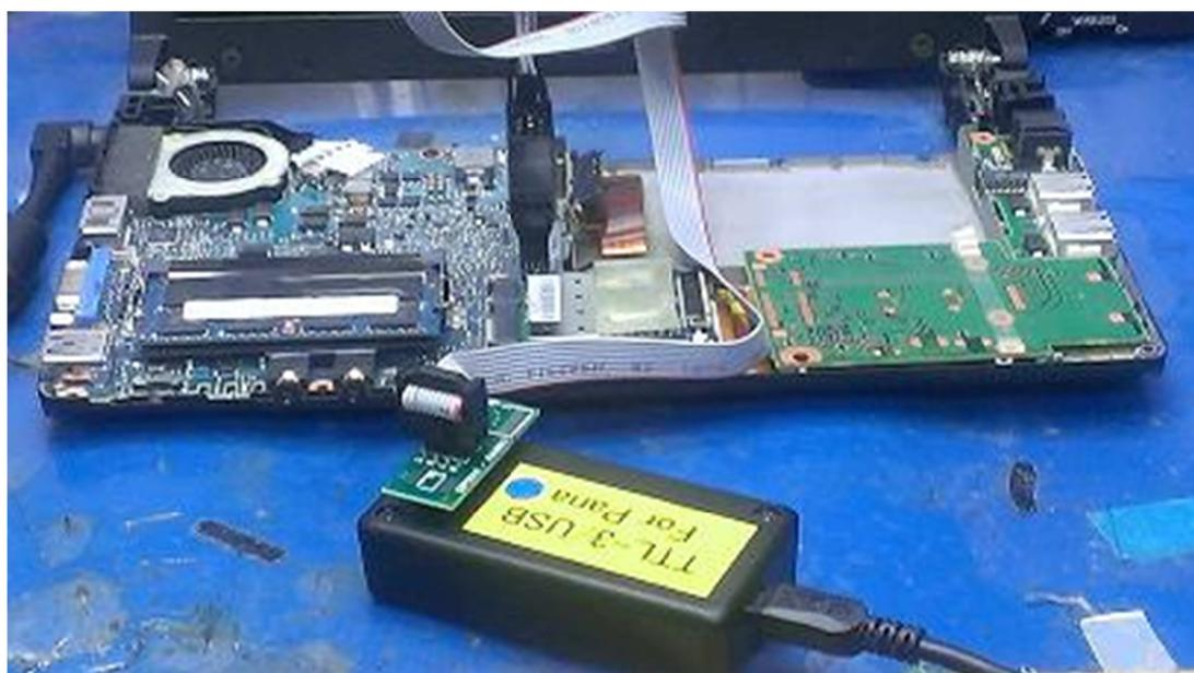
※SOP クリップの即目に V カットの傷（凹み）の有る所が 1 番ピンです。
