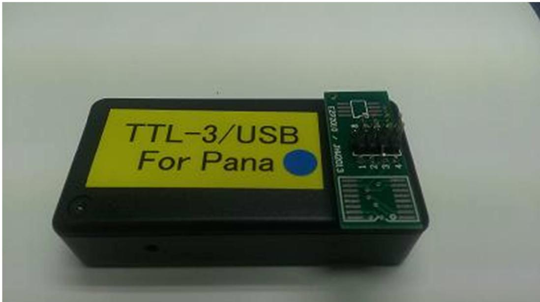
※TTL-3/USB\_PanaにSOICクリップ付属の拡張基盤を取り付けた図
